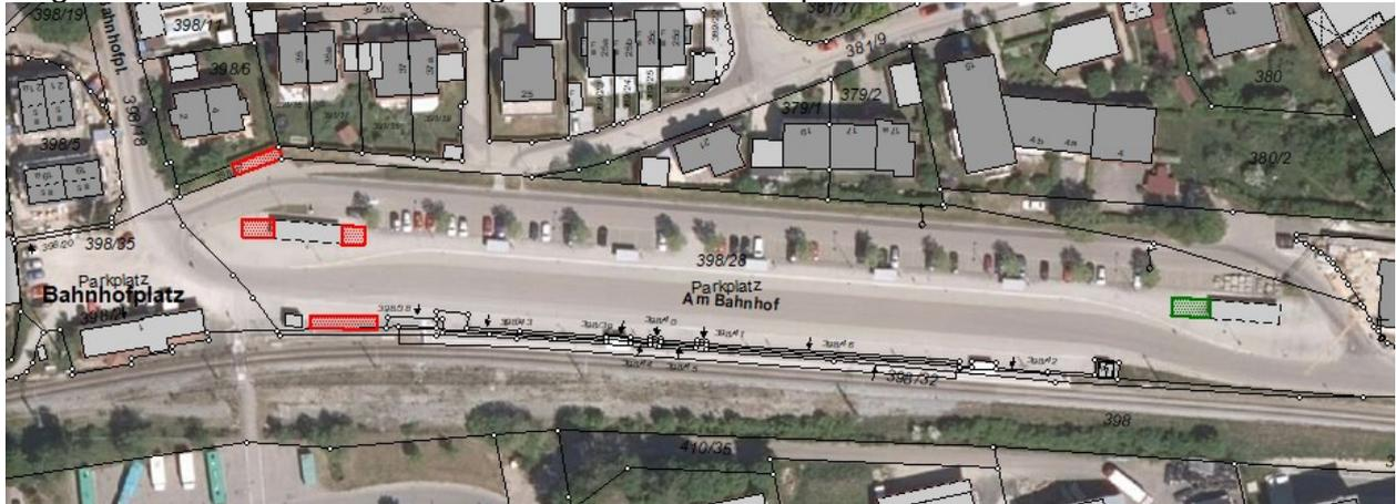
Die rot dargestellten Flächen sollen mit überdachten Fahrradbügeln ausgestattet werden, wie sie bereits vorhanden sind. Die im Osten grün eingezeichnete Fläche wäre eine abschließbare Sammelschließanlage, bei der z. B. mittels Smartphone-App der Zugang geregelt wird für bis zu 18 Stellplätze für z. B. eBikes.
